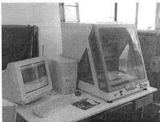
1. ábra. A CPM 4030 háromtengelyű CNC marógép és vezérlő számítógép
