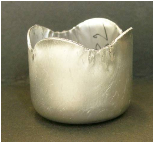
2. ábra. A Ø68mm-es tárcsaátmérőből mélyhúzott csészek baloldalt bevonat nélkül, jobboldalt TiAlN bevonatú bélyeggel mélyhúzva
