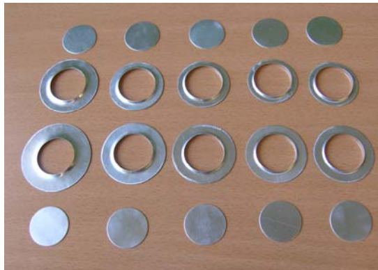
6. ábra. Kivágott munkadarabok
