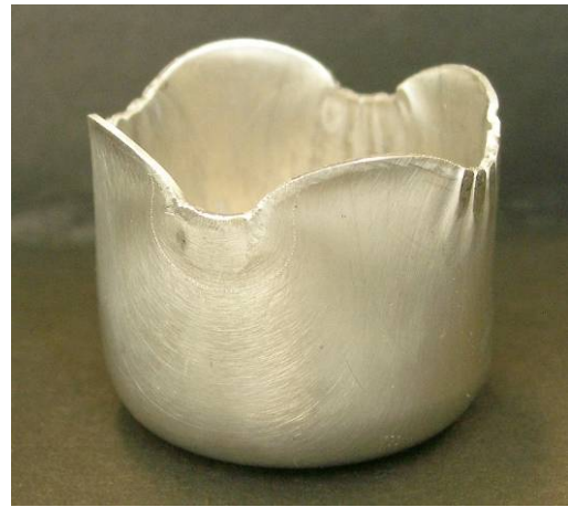
2. ábra. A Ø68mm-es tárcsaátmérőből mélyhúzott csészek baloldalt bevonat nélkül, jobboldalt TiAlN bevonatú bélyeggel mélyhúzva
